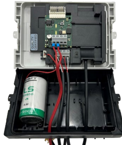
Figure 5 Beispiel für die Verdrahtung der Stromversorgung
