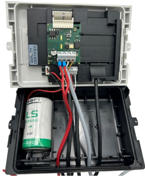
Figure 7 Anschließen der EIA-485-Schnittstelle
